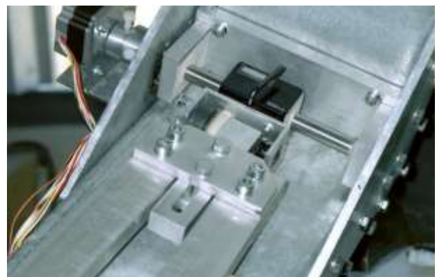
Abb. II.28 Deklinationshelb und Wälzmuttergetriebe
