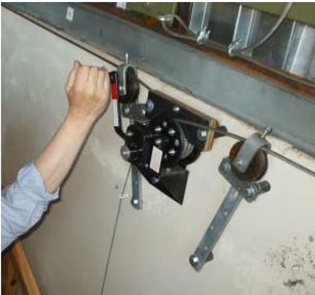
Abb. II.30 Der Rolldachantrieb mit Totmannbremse (unteres Seil)
